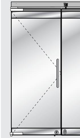
Die Anschlagtür mit AT-Hebeln lässt sich um 180° schwenken und erlaubt somit eine völlige Freigabe des Anlagenverlaufs. Ein unteres Riegelschloss sichert den geschlossenen Flügel.
